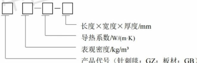
4.2.1.2 长度×宽度×厚度为3600mm×600mm×50mm、导热系数为0.032W/(m·K)、表观密度为96kg/m<sup>3</sup>的硅酸盐固废针刺毡标记为：GZ 96—0.032—3600×600×50。
